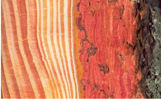
Siperianlehtikuusen poikkileikkaus. Huomaa, että Pintapuuta on vain 6 vuosilustoa.
